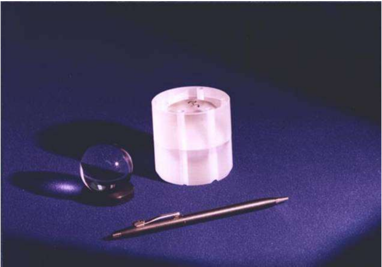
Vue du Gyroscop ( en quartz non métallisé) et de sa coquille en quartz
